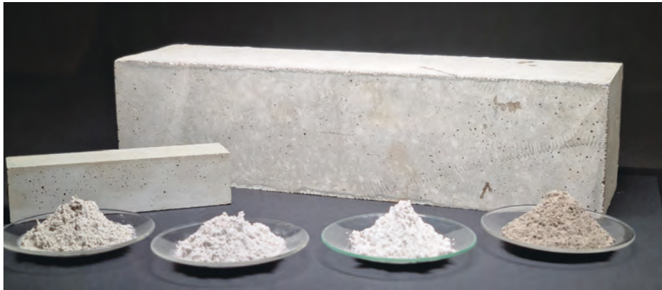
5 Van links naar rechts: portlandcement, gemalen gegraneerde hoogovenslak, kalksteenmeel, poederkoolvliegias (op de achtergrond een betonprisma)
